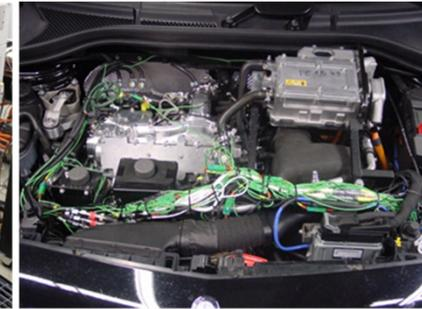
Integration der Leistungselektronik im Fahrzeug
