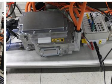
Verwendete Fahrzeug-Leistungselektronik in den EM-Prüfstand integriert
