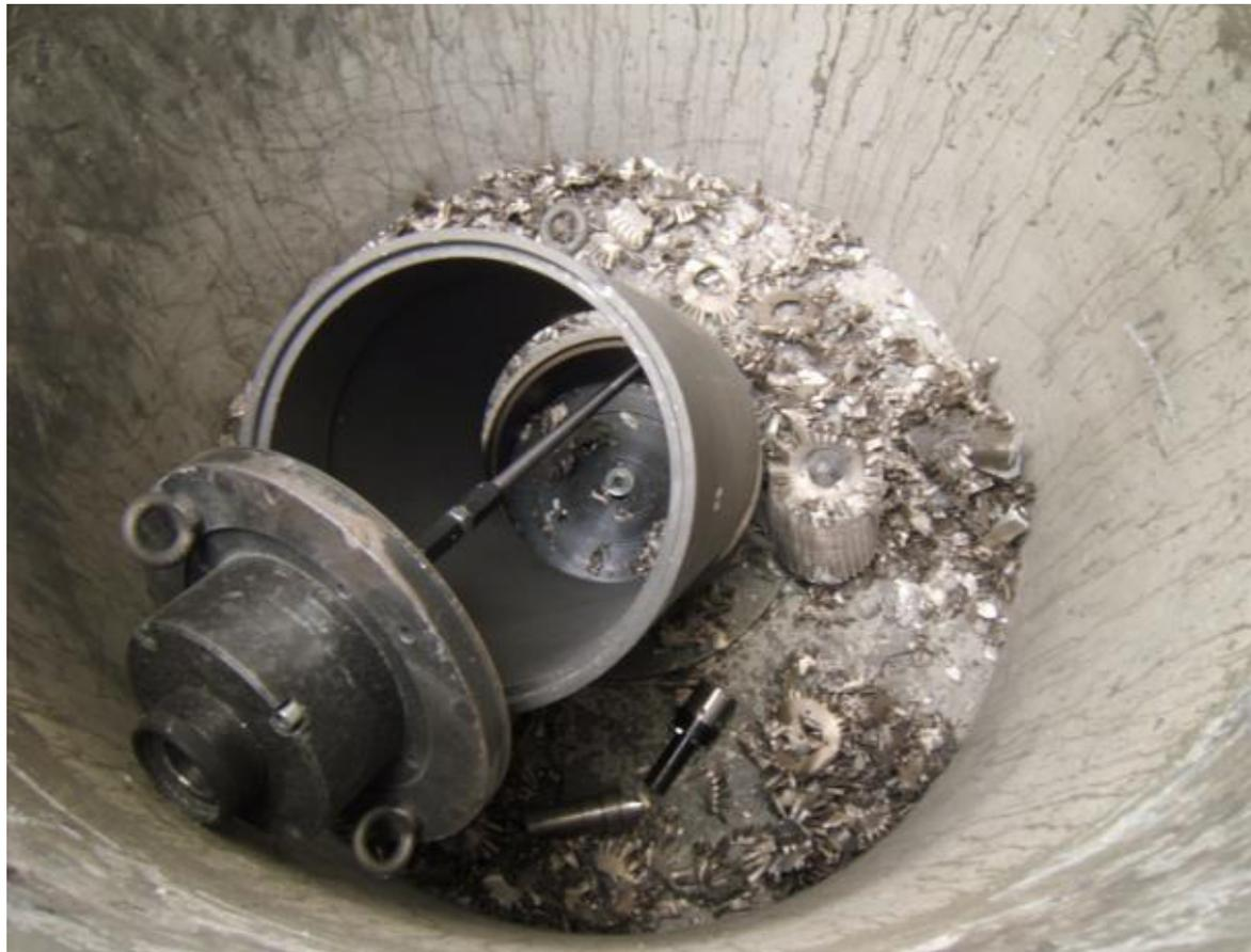
Totales Versagen des Rotors mit Abreisen der Antriebskupplung
