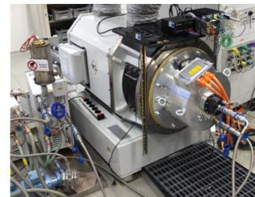
Verwendete PMSM an dem EM-Prüfstand montiert und verkabelt
