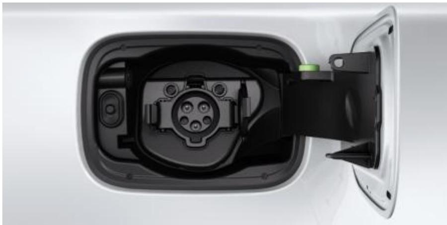
Abbildung 14: Anschluss für SAE J1772 Stecker
