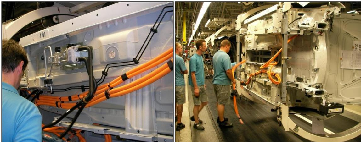
Abbildung 29 / 30: Einbau eines des Wärmetauschers und des HV- Kabelbaums.
