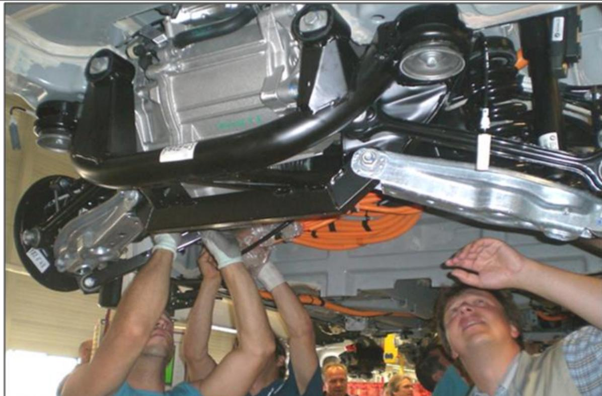
Abbildung 33: Kontrolle und Nacharbeit im Anschluss an den automatischen HVS-Einbau.
