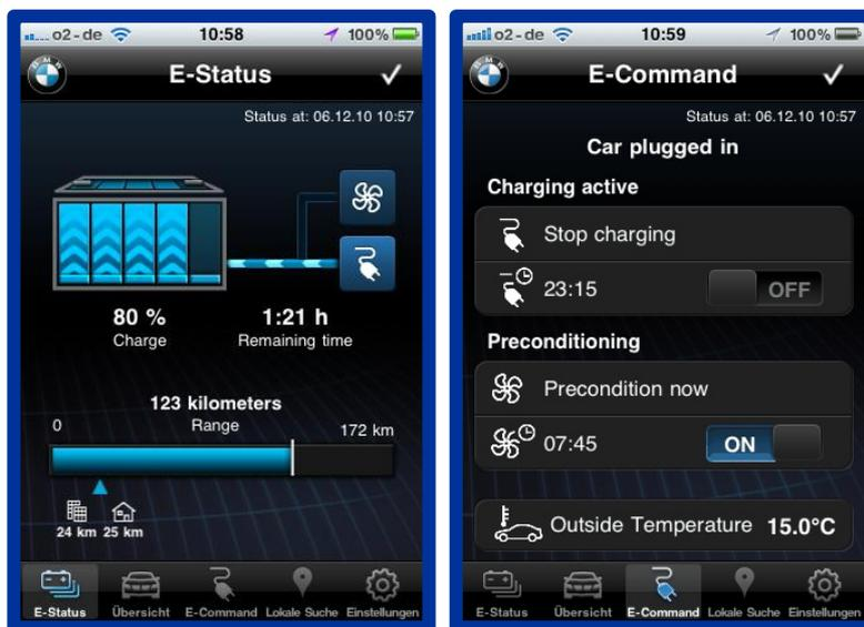
Abbildung 24 / 25. Smartphone Anzeige und Funktionssteuerung.
