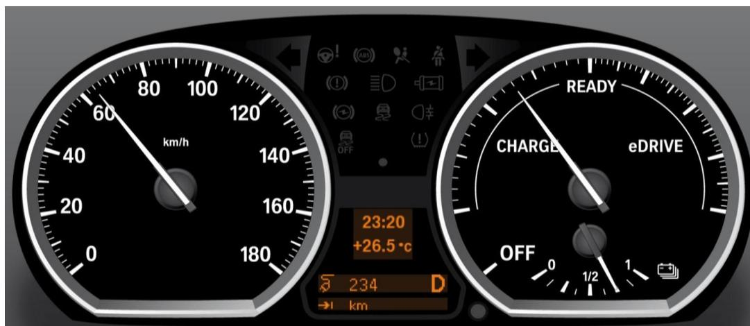
Abbildung 23. Aufteilung der Analoganzeigen und Erweiterung der Anzeige um Ladezustand
