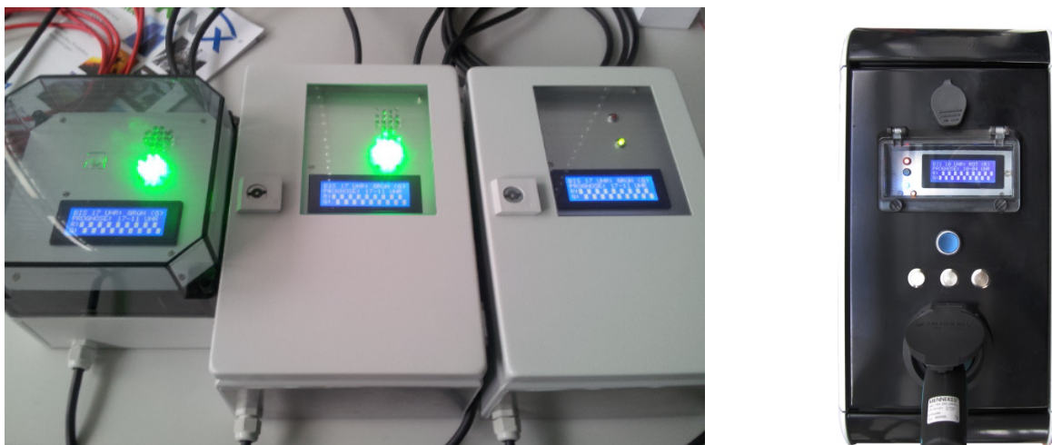
Abb. 3.9: Unterschiedliche Designs der Signalboxen (links) und steuerbare Ladestation mit Raspberry Pi (rechts)
