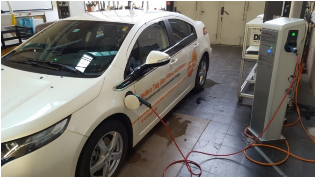
Abb. 3.47: Kompatibilitätstest für gesteuertes Laden am Versuchsstand der TU Darmstadt
