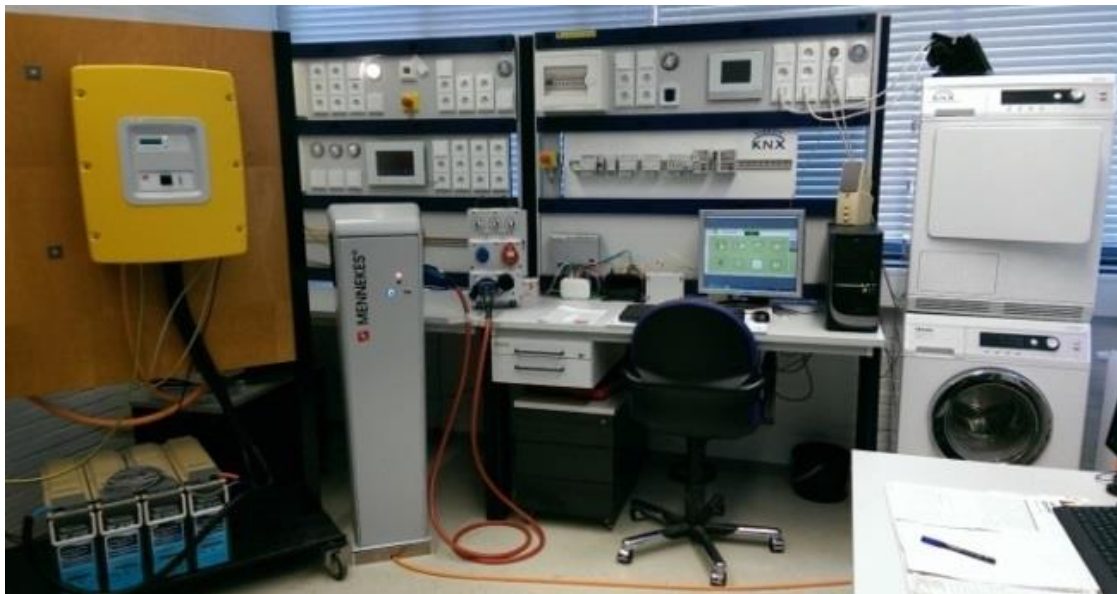
Abb. 3.42: Versuchsstand der TU Darmstadt zur Entwicklung des Energiemanagementsystems [15]
