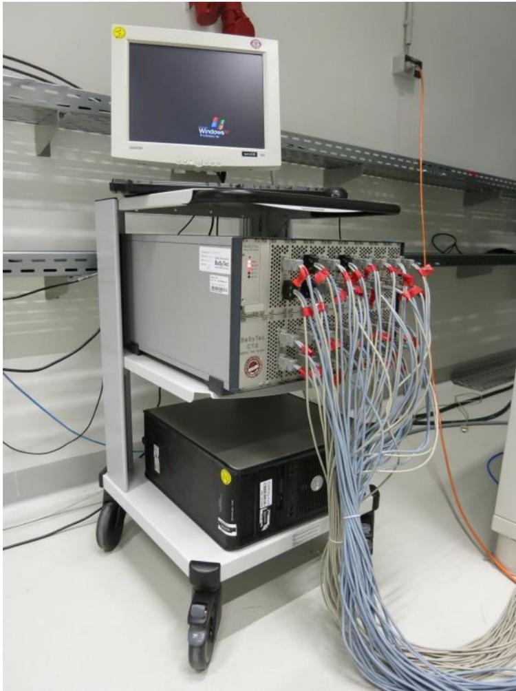
**Abbildung 3: Testaufbau des StaTrak Batterietestsystems**
