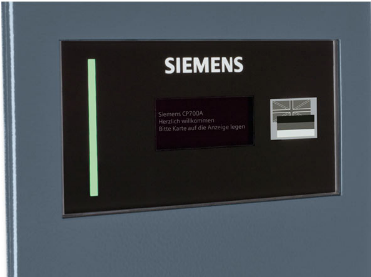
Display mit Antennenfenster für die Erfassung der ID-Karte
