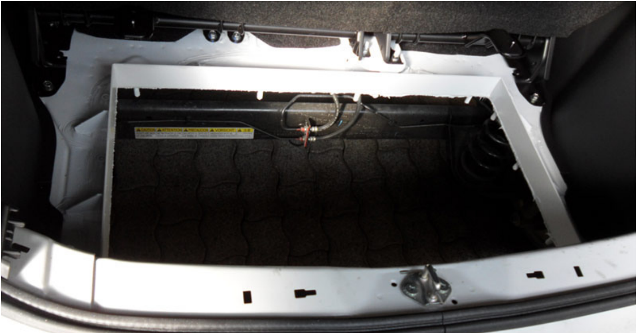
Kofferraumausschnitt für Batterieaufnahme: Detailoptimierung für Montage und Heckaufprall
