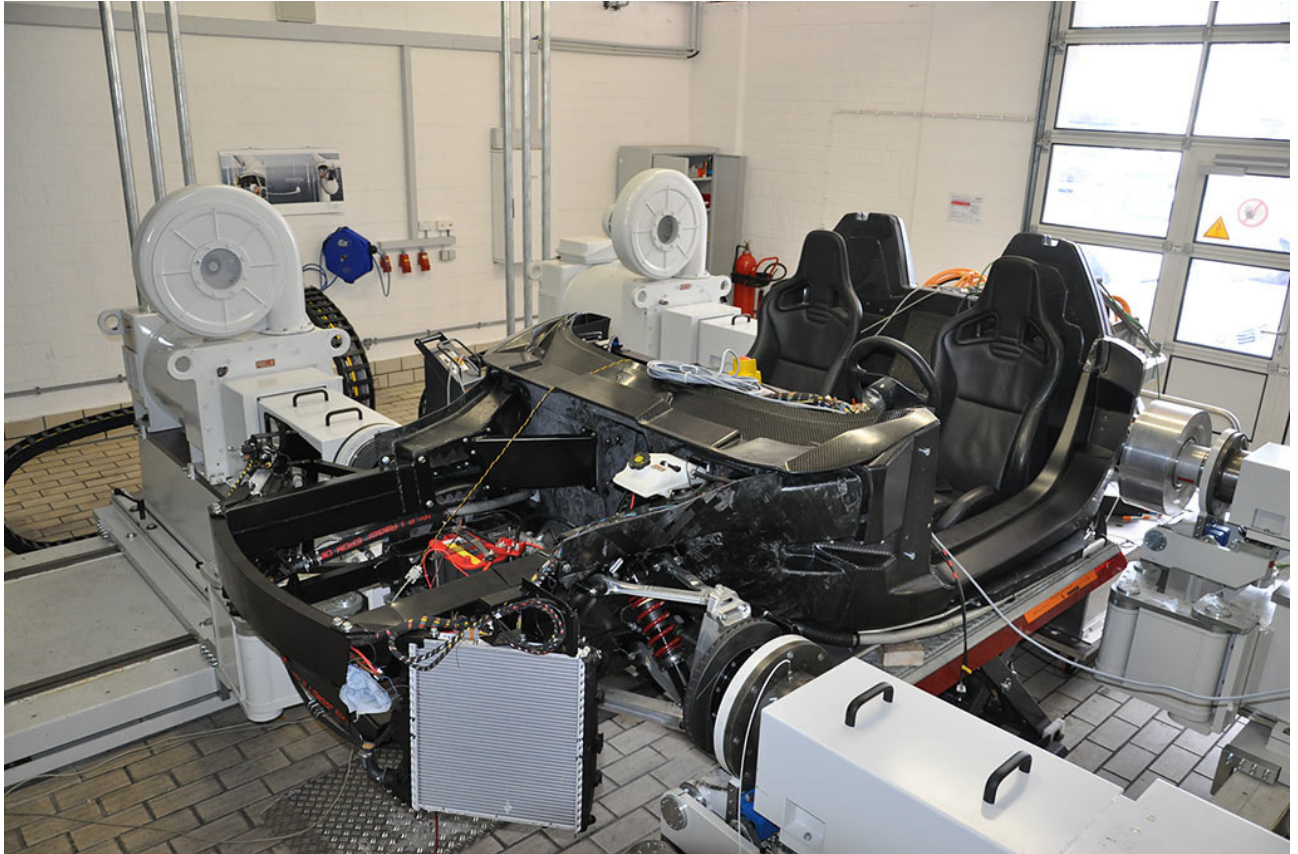
Fahrzeugchassis mit Radnabenmotoren auf neu eingerichtetem Motorprüfstand
