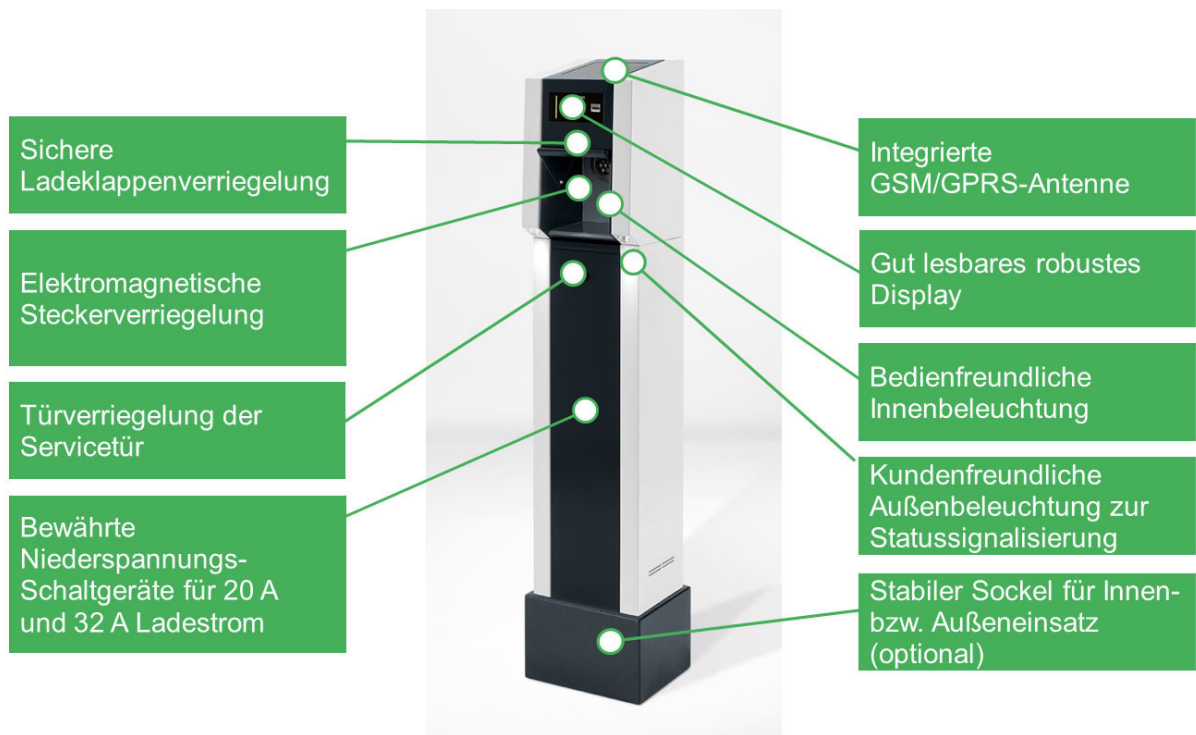
Technologiebaustein Ladesäule: Schnittstelle für Kommunikation und Energieversorgung
