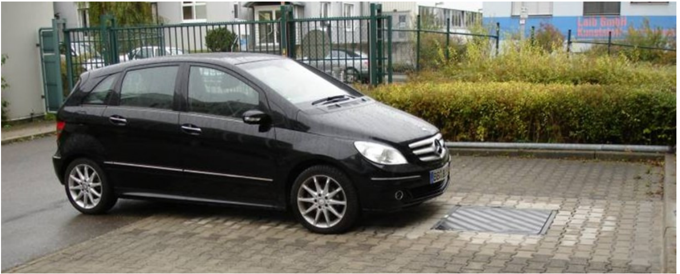
Abbildung 76: Induktiver Außenladeplatz und Erprobungsträger
