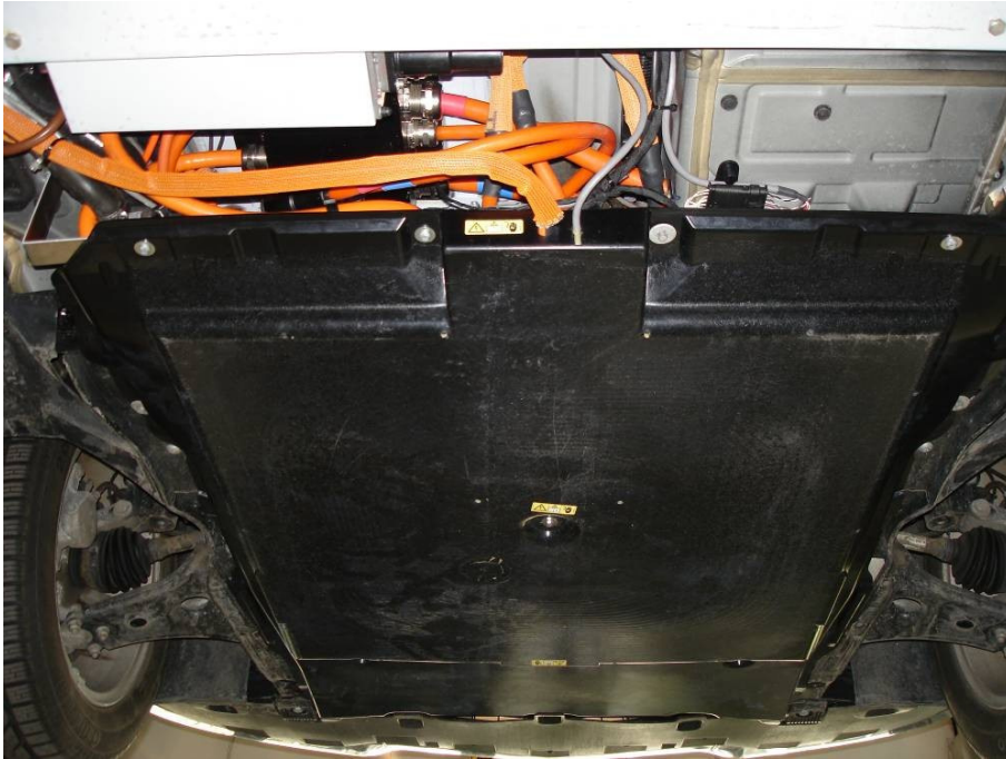
Abbildung 73: Bodenansicht des Erprobungsträgers mit integrierter Sekundärspule in die Unterbodenverkleidung
