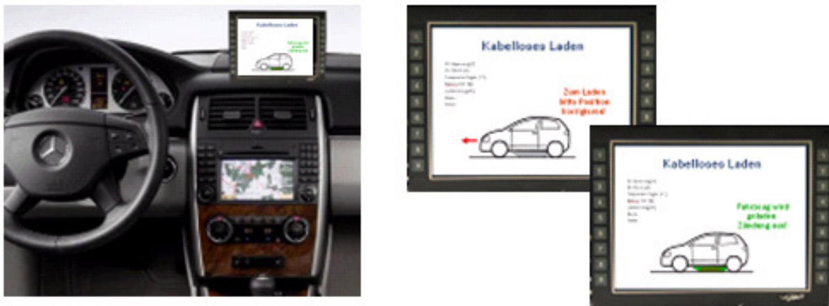
Abbildung 71: Visualisierung des Ladevorgangs und Positionierung
