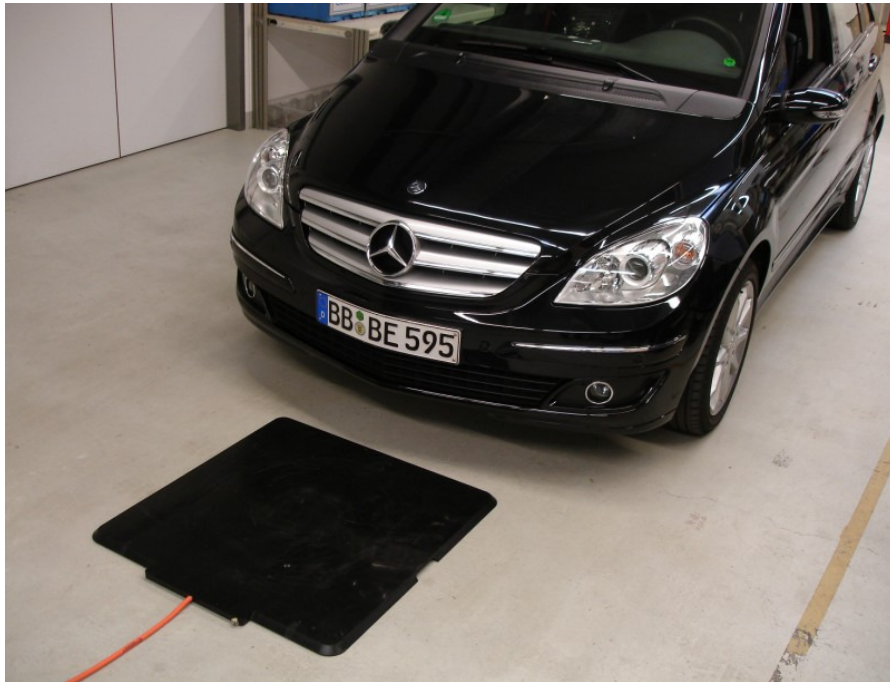
Abbildung 74: Induktiver Ladeplatz mit Primärspule und Erpobungsträger
