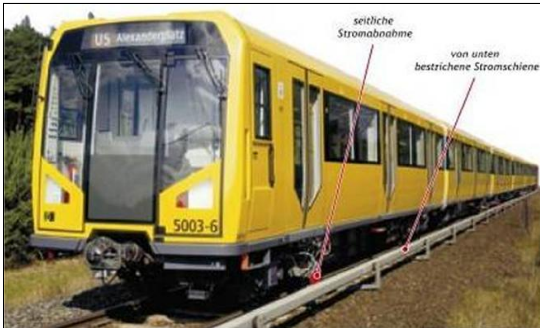
Abbildung 2-10 U-Bahn mit Stromabnehmer und Stromschiene [21]
