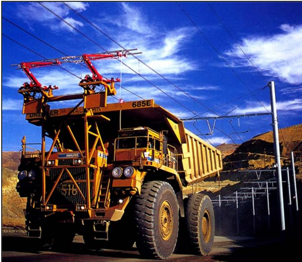
Abbildung 2-5 Dump-Truck mit Trolley-Assist und zweipoligem Stromabnehmer [13]
