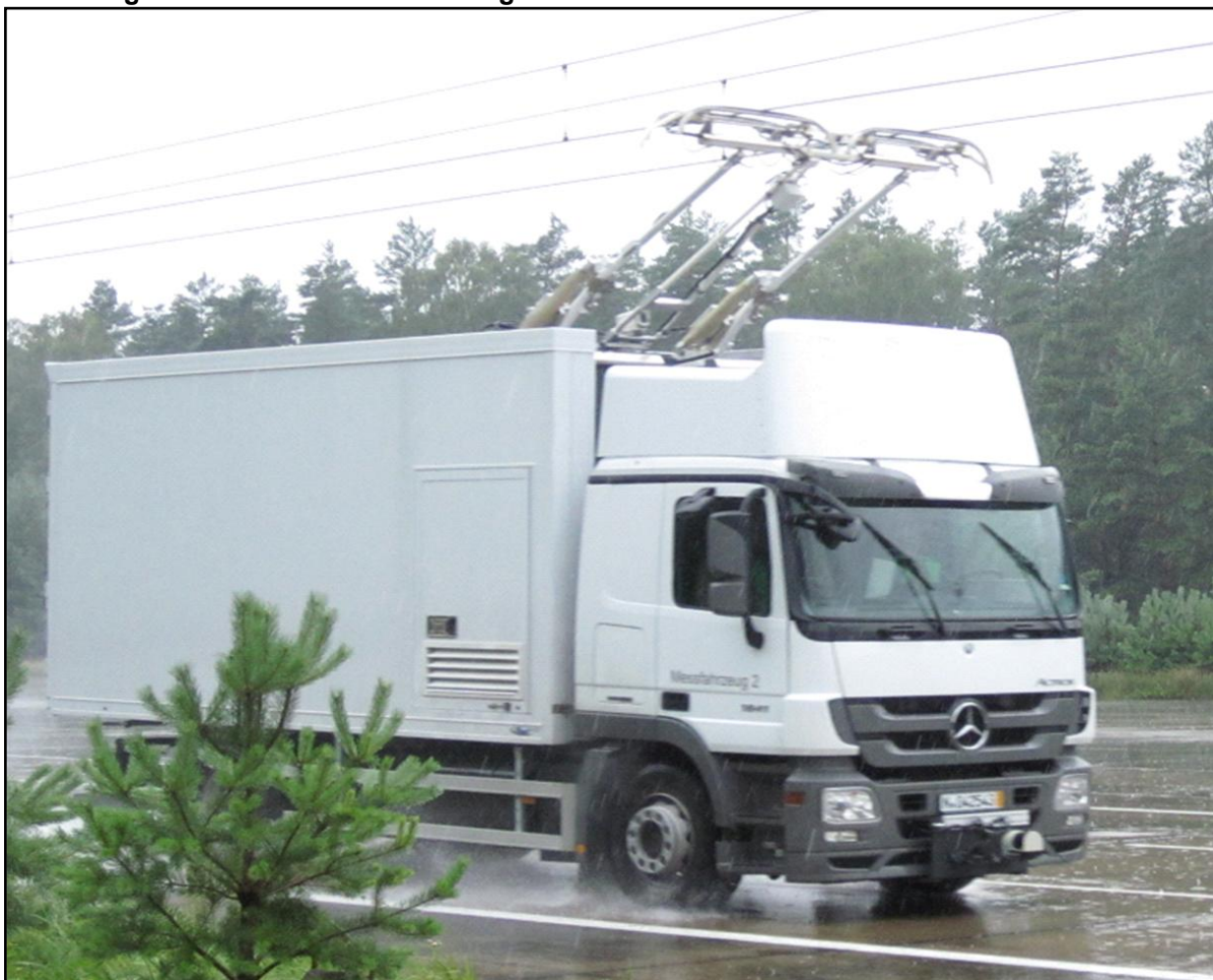
Abbildung 3-29 Funktionstests bei Regen und Gischt
