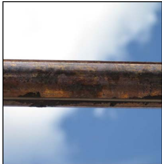
Abbildung 3-27 Schleifleistenabrieb durch Bewegung im Stillstand
