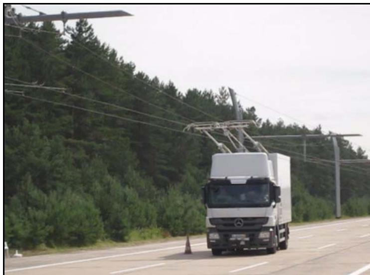
Abbildung 3-23 Nachregelung Stromabnehmer bei Spurdrift
