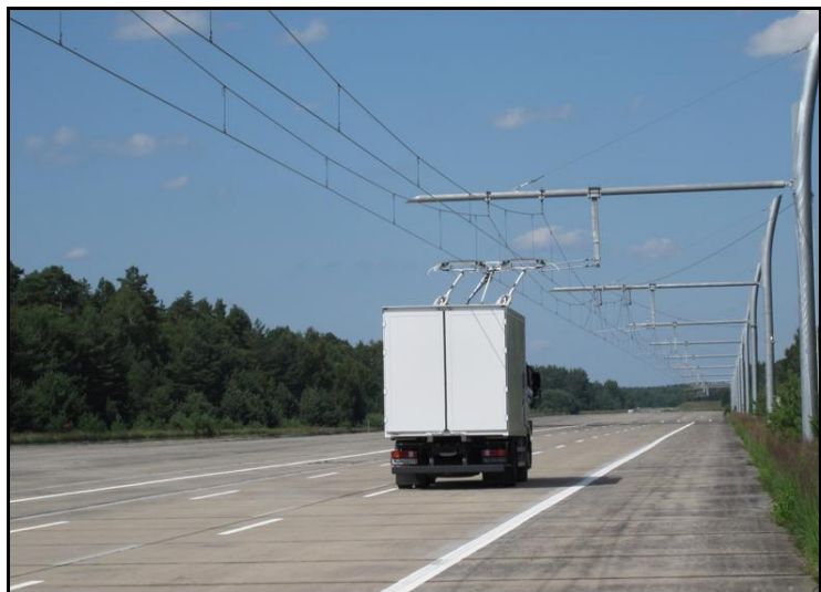
Abbildung 3-23 Nachregelung Stromabnehmer bei Spurdrift
