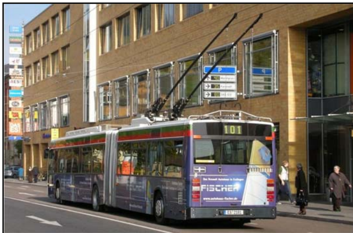
Abbildung 2-4 Obus mit Einfach-Oberleitung und Stangenstromabnehmer [19]
