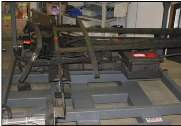
Abbildung 3-5 Defekter Stromabnehmer [40] Abbildung 3-6 Fahrleitungsschaden [40]
