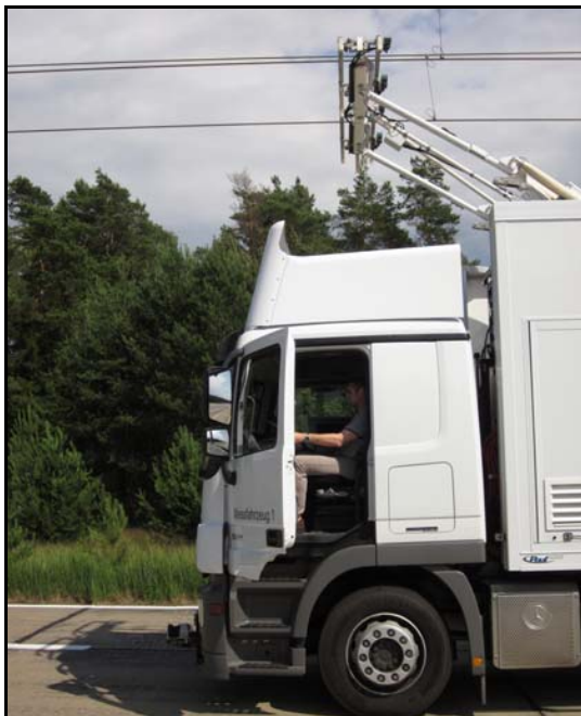
Abbildung 3-19 Kontrolle der Stromabnehmerbewegung im Stillstand
