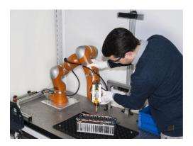
Abbildung 7: Konzept eines Demontagearbeitsplatzes mit Roboterassistenz (links) und Umsetzung in der Pilotanlage (rechts)
