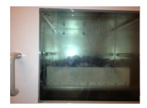
Abb.1: Vakummtrockenschrank (links), geschreddertes Batteriematerial in Vakuumtrockenschrank (rechts)
