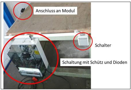
Bild 3: Arbeitsplatz zur Entladung von Batteriezellen (Quelle ECG)
