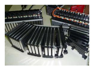
Abbildung 28: "kleines"-15-Zellen-Batteriemodul der Firma Sanyo
