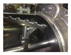
Abb. 11: Geöffneter Trockentrommel mit Rührerwelle und Paddel
