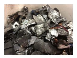
Abb. 5: Aus Schreddergut aussortierte Metallteile
