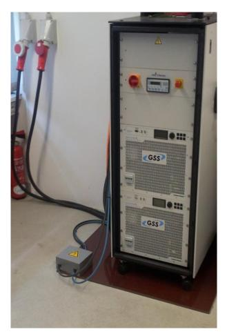
20 KW Entladegerät (Senke bis 1.000 V DC)
