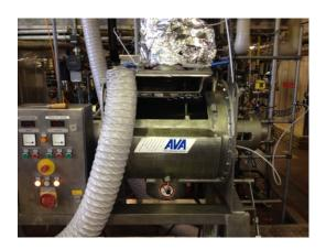
Abb. 12: Trommeltrockner mit geöffneter Einfüllöffnung und Punktabsaugung
