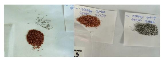
Abbildung 26: Maximaler Gehalt an Kupfer- und Aluminiumfolie
