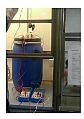
Abbildung 11:Variante C: Zellentladung in leitfähigen Salzwasser (links: Prinzips-Skizze Strom-/Spannungsmessung; Mitte: Zellhalterung; rechts: Versuchsaufbau)
