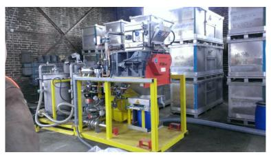
Abbildung 5: HV Batterie Zerkleinerungsanlage: Mobileshredder von VW
