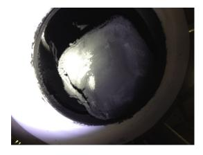
Abb. 19: Anbackungen am Schlauchfilter (Mitte) und an der Filterwand
