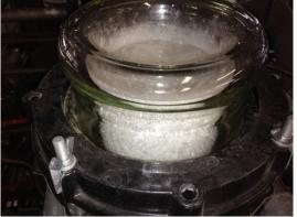
Abb 15: Kühlfallen mit auskristallisiertem Elektrolyten
