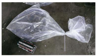
Abbildung 6: Q5 HV-Batteriemodul und zerkleinertes Material
