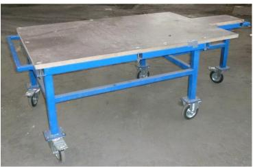
Bild 1: Demontagewagen für "große" Batteriesysteme (Quelle ECG)
