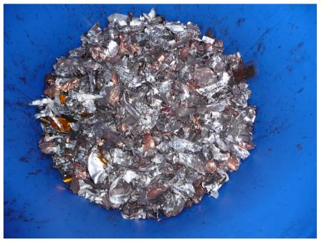
Bild 5: Zerkleinerungsprodukt (Li- Zellen) des mobilen Shredders (Quelle ECG)
