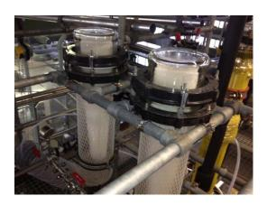
Abb. 8: Kühlfallen zur Kondensation von Elektrolytlösemitteln
