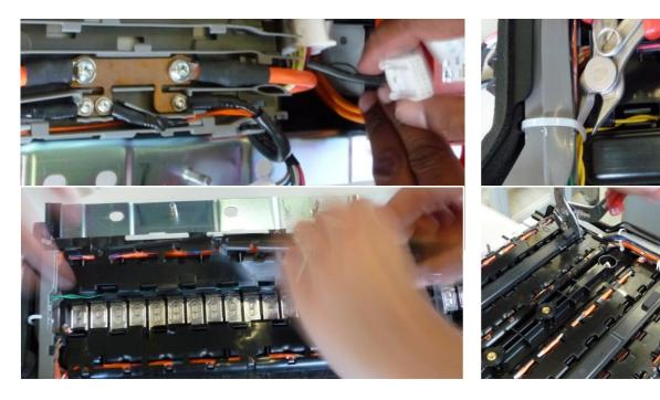
Abbildung 2: Manuelle Demontageversuche an Batteriesystemen (Wegener et al. 2014)
