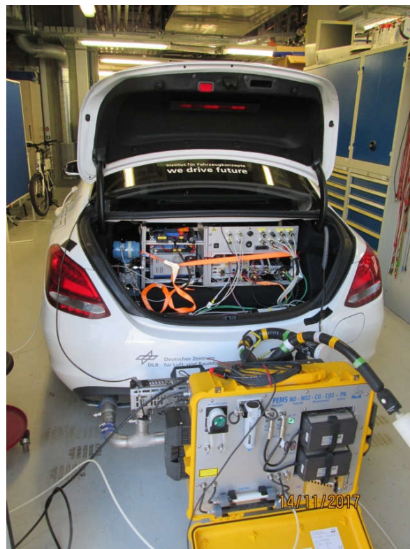
Abbildung 28: Mercedes C350e mit Messtechnik und PEMS
