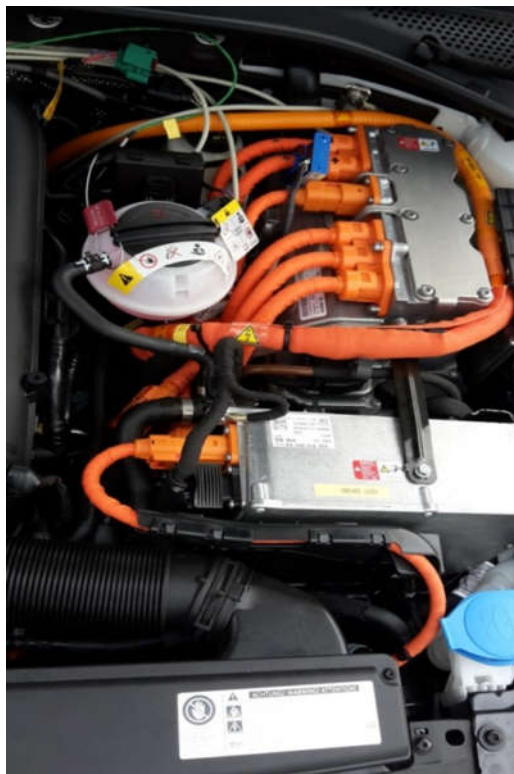
Abbildung 18: Motorraum des Golfs. In Draufsicht: Inverter/Leistungselektronik (Silberfarbe), Hochspannungskabel (orange) und Stromzange (blau oben)
