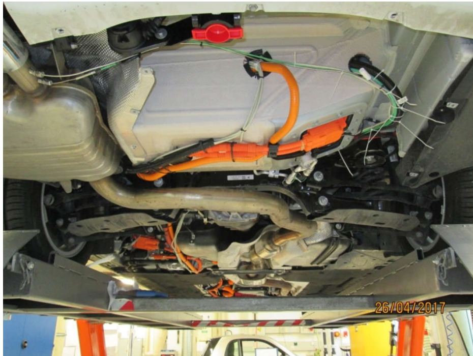
Abbildung 24: Unterboden des BMW mit den von der Batterie zur Leistungselektronik geführten Hochvoltkabeln (orange)
