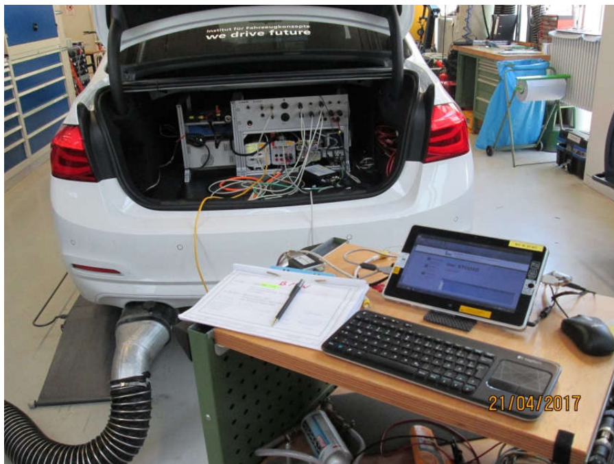
Abbildung 25: Inbetriebnahme des Messtechnik- und Versorgungsrack im BMW
