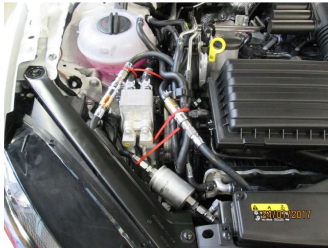
Abbildung 19: Kupplungen und Leitungsverlängerung der Kraftstoff Hin- und Rückführung zum Kraftstoffmesssystem im Golf
