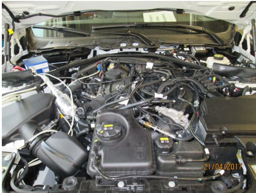
Abbildung 23: Motorraum des BMW mit eingebautem Kraftstoffdurchflusssensor
