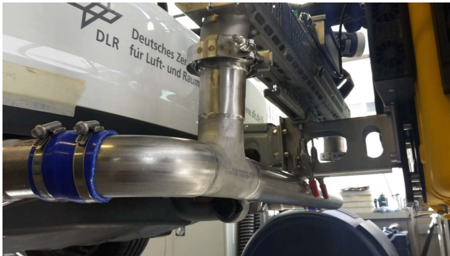
Abbildung 26: Doppelrohr-PEMS-Abgasadaption am Mercedes C350e
