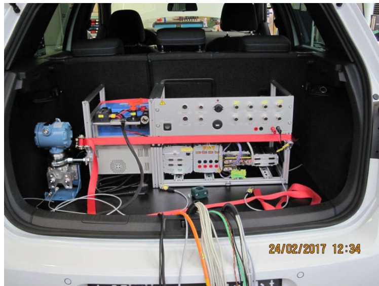
Abbildung 17: Messtechnikrack mit separater Batterie und Messwerterfassungseinheit
