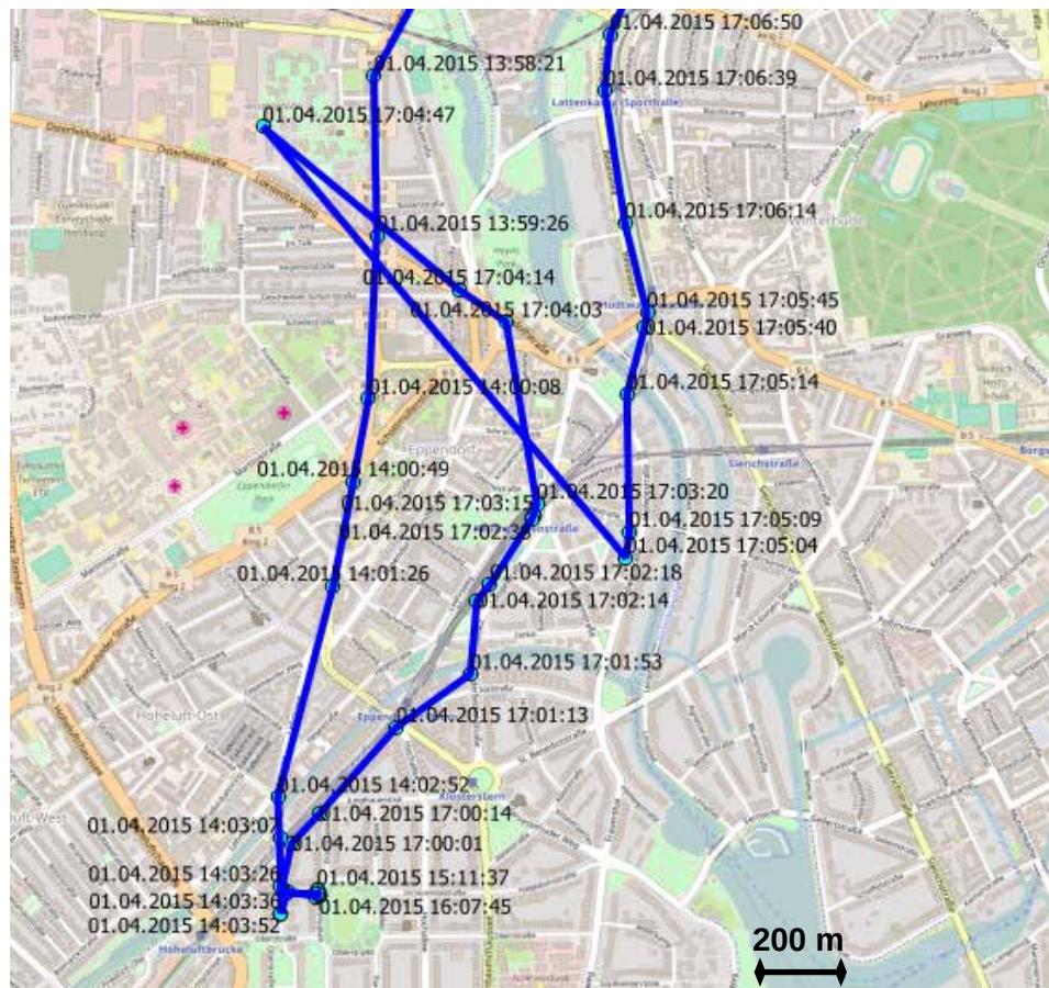
Abbildung 3-1: Beispiel für einzelne Signalfehler per GPS-Gerät
