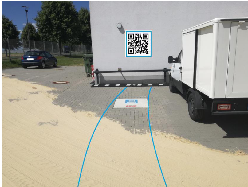
Abbildung 18: Vorpositionierung mit Fahrschlauch
