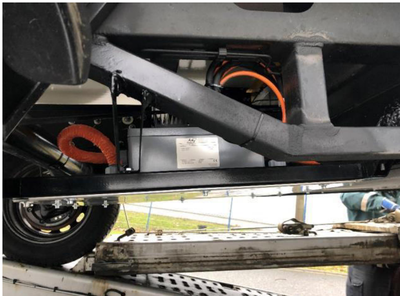
Abbildung 16: Sekundärspule inkl. Spulengestell sowie Box mit Leistungselektronik integriert in Fahrzeug
