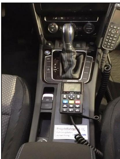
Abbildung 16: Exemplarische Anbringungssituation in einem Funkstreifenwagen (PHEV)
