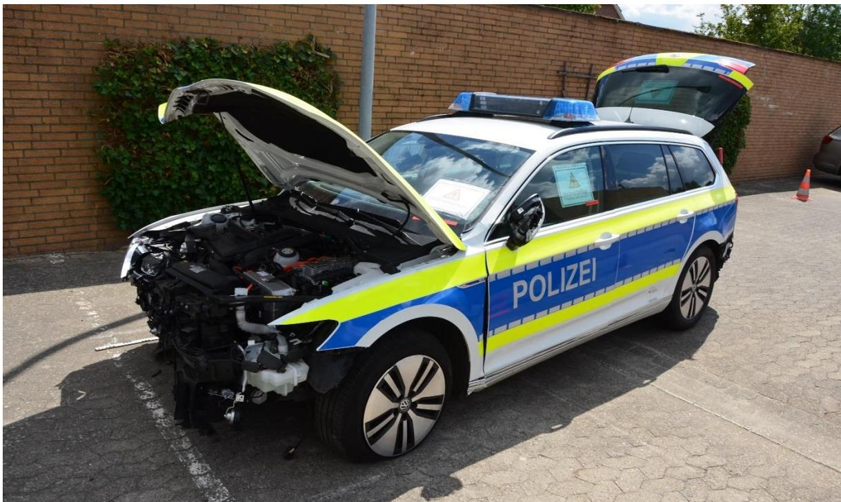
Abbildung 42: FUSTW (PHEV) nach einem Frontalzusammenstoß vor der Aussonderung
