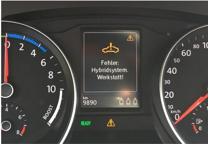
Abbildung 41: Fehlermeldung eines FUSTW (PHEV)
