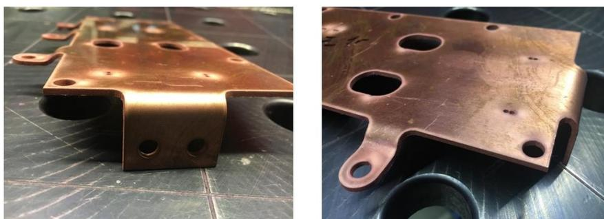
Abbildung 48: Umgeformte Stromschien für den Aufbau des Prototypen
