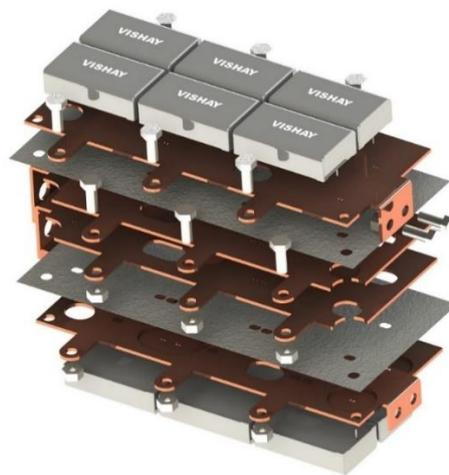
Abbildung 15: Explosionszeichnung des Folienzwischenkreises
