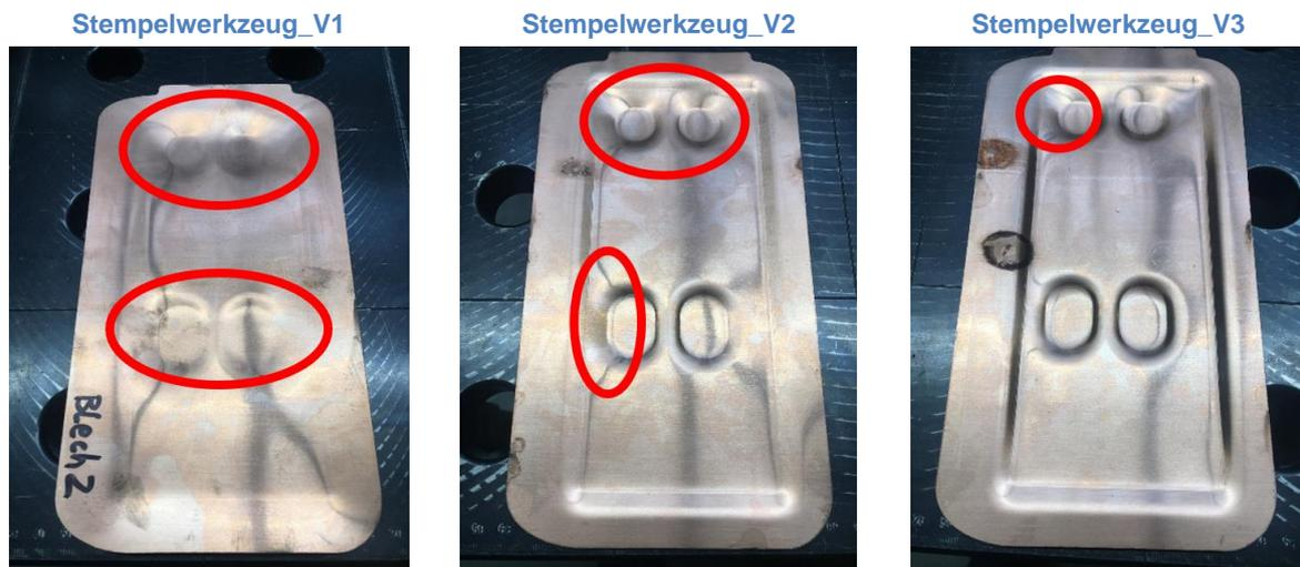
Abbildung 53: Versuchsbleche des Demonstrationswerkzeuges. (links) niedrige Pressen- und Niederhalterkraft; (mitte) einfach umgeformtes Demobauteil; (rechts) doppelt umgeformtes Demobauteil
