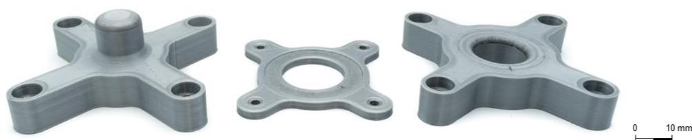
**Abbildung 27: Dreiteiliger Werkzeugsatz aus PLA. Stempel (links), Niederhalter (mittig) & Matrize (rechts)**
