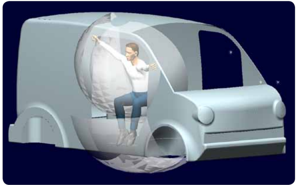
Abbildung 247 Aussteigen über rechte Fahrzeugseite mit verschieb- & drehbarem Sitz. Hüllkurven der Erreichbarkeit für Hände & Füße bei gedrehtem Manikin & verschobenem Mock-Up
