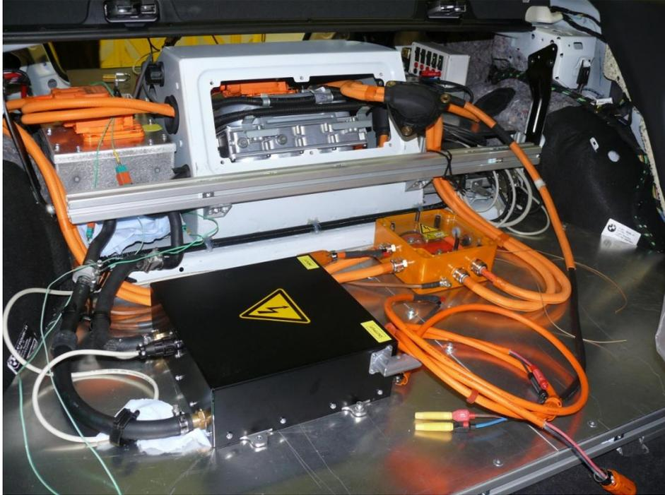
Abb 5: HV-Verteilerbox mit Kabelanbindungen (orange) und Leistungselektronik (schwarz) im Bereich der Rücksitze
