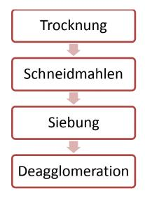
Abbildung B-21: Prozessfließbild der Trockenen Separation
