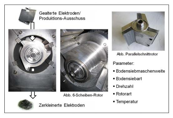
Abbildung B-22: Mechanische Separation in der Schneidmühle
