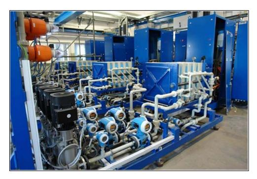
Abbildung B-36: EDBM-Anlage
