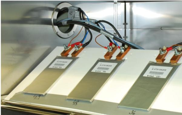
Teststand für Lithium-Ionen-Batterien. © Fraunhofer ISE
